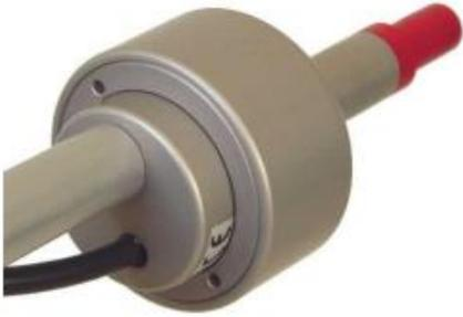
Installez le LipStick sur un statif stable. La sortie du câble doit se trouver sous l'appareil.
